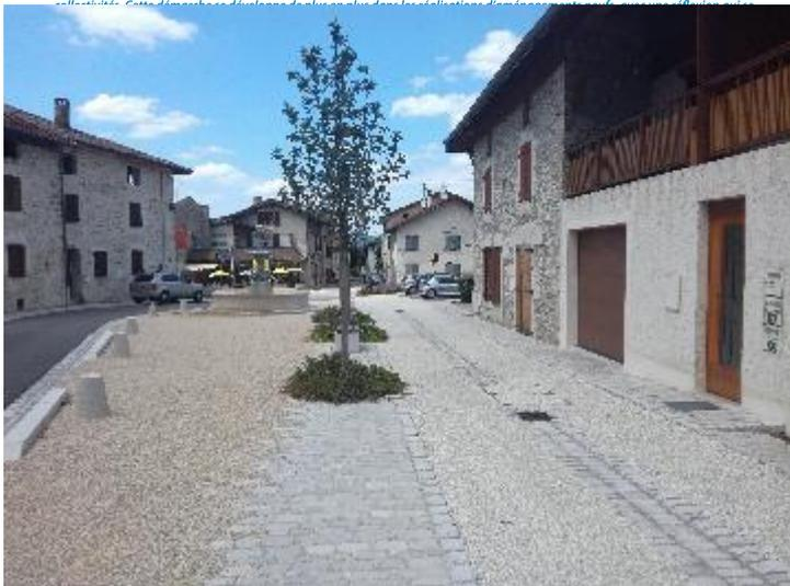
L'adaptation de l'existant pour permettre la gestion des eaux pluviales se resume parfois à une modification simple de l'espace (suppression de bordures, pente légère, changement de revêtement, ...). Des programmes d'entretien des espaces et des bâtiments permettent également d'améliorer la gestion pluviale.
